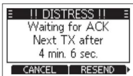
4. Cuando reciba un acuse de recibo, sonará una alarma, presione [ALARM OFF] para apagar la alarma.
