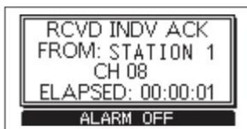
Presione la tecla programable **[ALARM OFF]** para desactivar la alarma, el canal asignado en el paso anterior se selecciona automáticamente.
