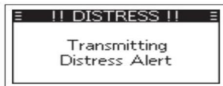
**NOTA:** Cuando el transceptor no recibe ningún dato de ubicación válido, los datos de ubicación almacenados se utilizarán para llamadas de socorro.
