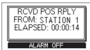
8. Presione la tecla suave [ALARM OFF] para apagar la alarma.
